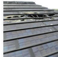
ホットスポットが起因した太陽 電池モジュール火災について
